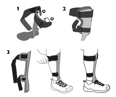
A almofada deve ser fixada medialmente, no lado interno da órtese, com as abas mais largas posicionadas na borda superior.
